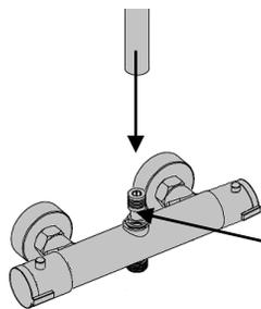
Il y a un film de protection sur les joints torique (sur le mitigeur), l'enlever avant d'emboîter.
