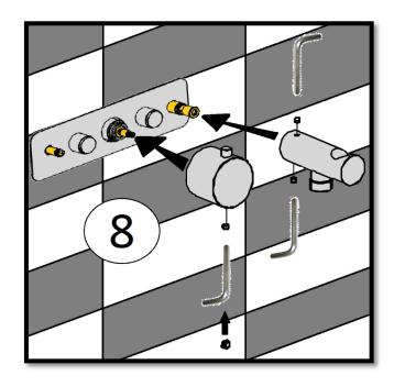
9-Placer désormais le tube, visser les 4 vis pointeau, en haut, au niveau de la fixation murale et en bas, au niveau du corps.
