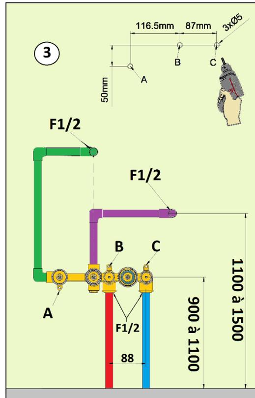
4-Finir son mur, ensuite percer le mur, pour fixer le raccord de fixation, de la prise d'eau murale.
