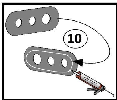
11-Continuer en faisant glisser la plaque de finition sur le corps encastré, jusqu'au mur, tenir ensuite fermement quelque seconde, pour que le joint silicone s'imprègne bien correctement contre la paroi du mur.
