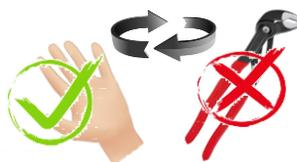
Le serrage du flexible se fait uniquement à la main, pas de pince nécessaire, cela provoquerait un écrasement du joint, puis une fuite.
