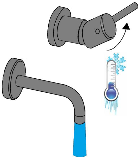
Ouverture eau froide
