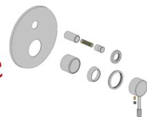
Placer finalement la manette sur la cartouche, puis bloquer là en vissant la vis pointeau à l'aide d'une clef Allen, dernièrement placer le cache vis dans le trou de la manette.
